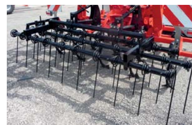
Herse à peignes simple rangée la herse à peigne conjuguée au rouleau arrière optimise un nivellement du sol.
