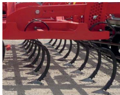
Écartement entre barres 640 mm Pas de risque de bourrage en présence de résidus
